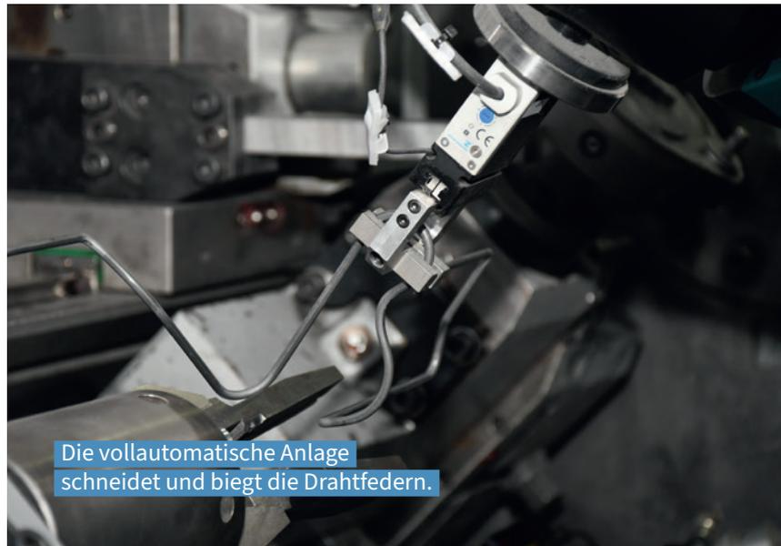
Die vollautomatische Anlage schneidet und biegt die Drahtfedern.
